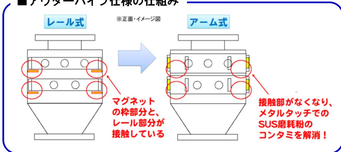
従来のレール式ハウジングの場合、ハウジング内のレール上にマグネットを置くように設置して使用するため、どうしてもインラインでメタルタッチが発生してしまいます…
