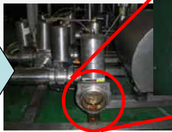
異物発生により破損したバルブ
