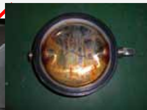
異物発生により破損したバルブ
